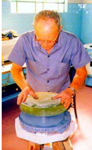
Figura 12 - Detalhe da confecção da curvatura em um vidro PIREX de 320 mm
