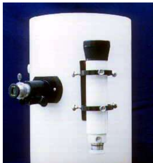
Detalhe da extremidade superior do tubo onde se localiza a luneta buscadora (direita) e o suporte móvel das oculares (esquerda)
